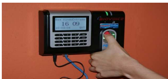
Figura 01 – Terminal de Controle Biométrico de Frequência nos Hospitais
